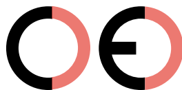
Falsche CE-Kennzeichnung (zu großer Zwischenraum)
