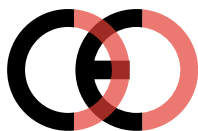
Falsche CE-Kennzeichnung (zu dicht)
